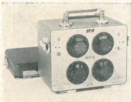
Una nuova linea di attenuazione di precisione variabile, è stata recentemente costruita dalla LEA (LAB. ELECTRO-ACUSTIQUE). Realizzata in due modelli, l'LHD1 (tarato in decibel) e l'LHN1 (tarato in neper), la linea di attenuazione è utilizzabile fino a 20 MHz con impedenza disimmetrica di 75Ω.
