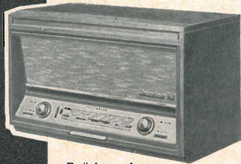
Radiofonografo DOMINO 61 RFS 7 valvole (compreso occhio magico) OM - 2/OC - MF elevata potenza e fedeltà di riproduzione.
